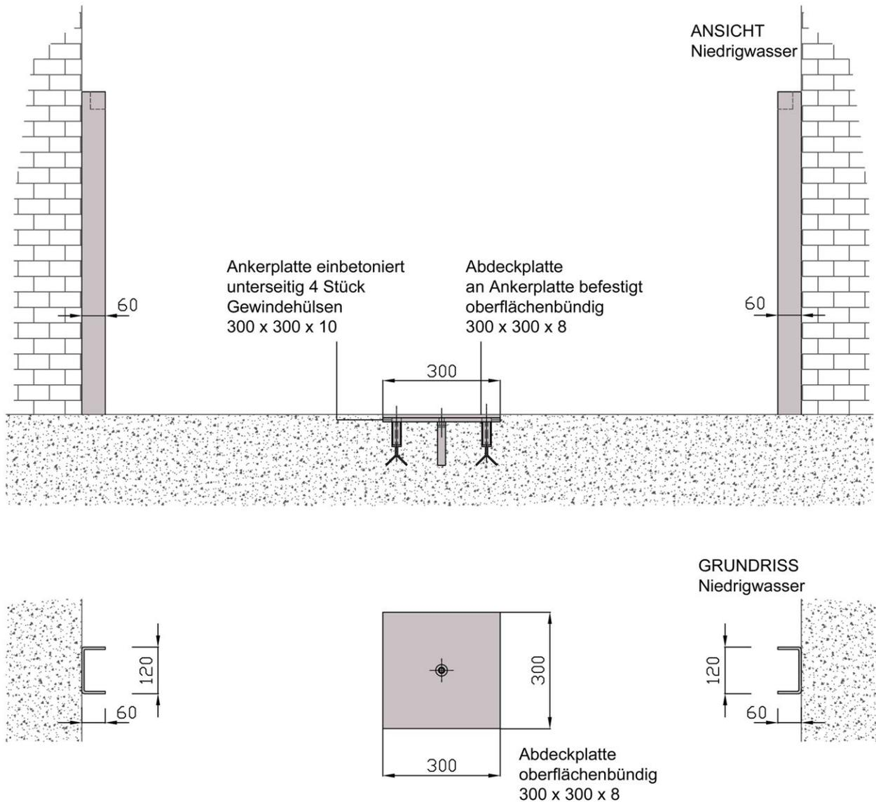
En état non-opérationnel les platines d'ancrage sont cachées sous des plaques de recouvrement en tôle larmée antiglisse, en inox, et résistant aux passages de véhicules. Ces plaques s'appliquent affleu-
