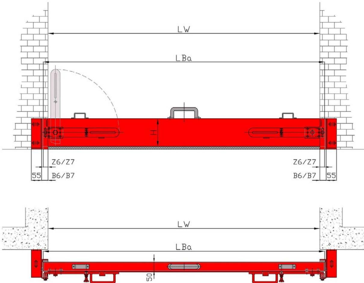
**BL/BTL (Système en éléments emboîtables, et recommandé pour des sites où l'on préfère une pose entre tableaux.)**
