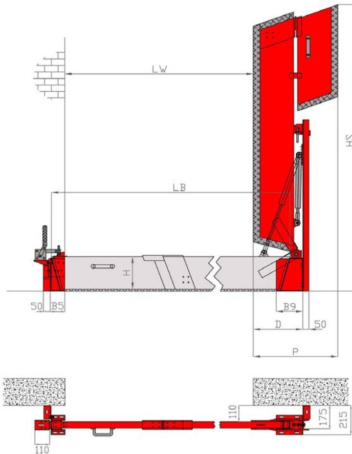
**BL/BED-KB (Barrière avec cloison rabattable d'un côté et élément repliable)**
